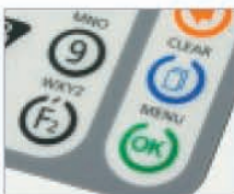
Leicht zu reinigende Folientastatur mit hervorstechendem Druckpunkt
